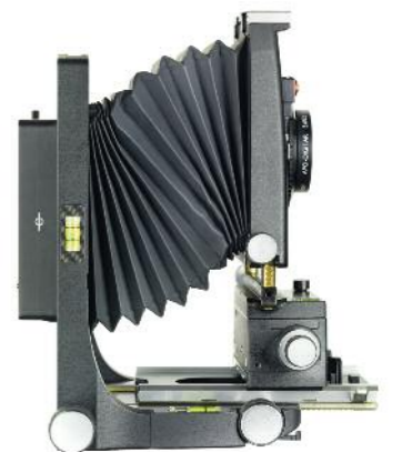
Oben: Hochshift an der Objektivstandarte, Tiefshift an der Bildstandarte zur Vermeidung stürzender Linien.
