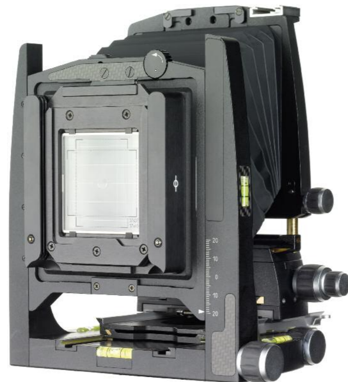
Die Fokussierung erfolgt präzise über den Kameraauszug. Das 3fach Schlittensystem gestattet sehr große Auszüge bis 250 mm als Voraussetzung für langbrennweitige Objektive oder für Aufnahmen im Nahbereich.
